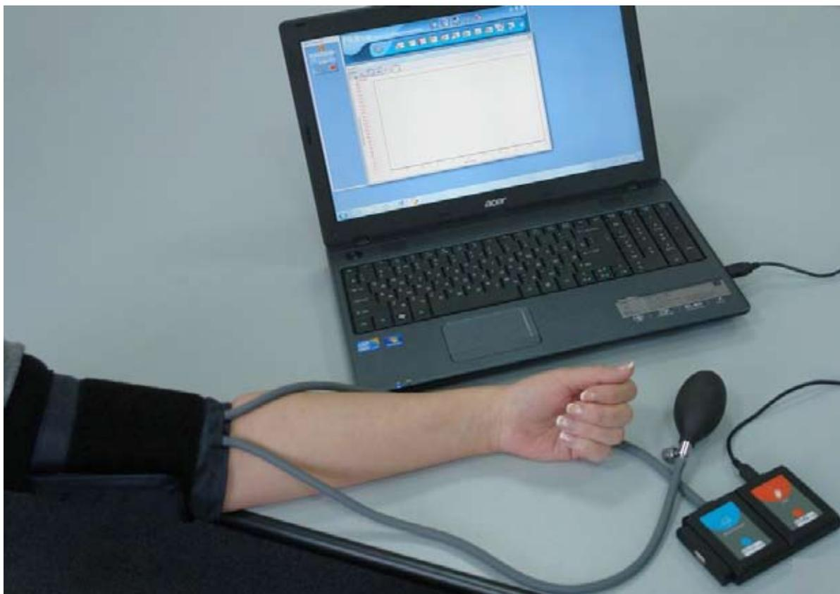
Рис. 7. Размещение манжеты измерительного модуля на руке испытуемого
